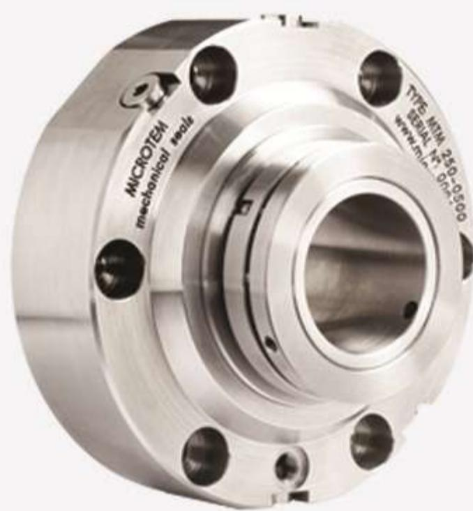
مکانیکال سیل های کارتريجي سری MTM250 به طور خاص جهت نصب بر روی ماشین آلات دوار از جمله کمپرسورها و توربین ها طراحی شده است و امكان تولید آن با متریال های مختلف هم برای قسمت سطوح لغزشی و هم برای بدنه سیل موجود می باشد. این نوع مکانیکال سیل ها توانایی تحمل سرعت هایی تا حد ۳۲ متر بر ثانیه را دارا می باشند. این سیل ها در قطر های 40mm تا 200mm
