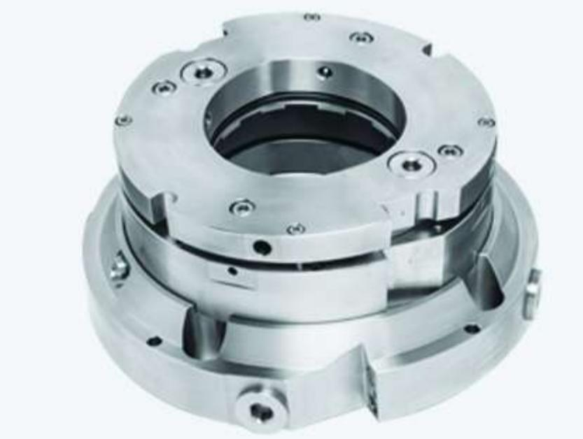
در مدل MTM850 (full Split) که به صورت کامل چاک دار می باشد، نصب مکانیکال سیل بدون دمونتاژ تجهیز امکان پذیرمی باشد. قسمت pumping ring استفاده شده در بخش چرخدنده در نوع خود بی نظر بر بوده و باعث توزیع بیشتر سیال در بخش داخلی شده که منجر به افزایش توان دفع تجمع حرارتی در سطوح تماسی می گردد.
